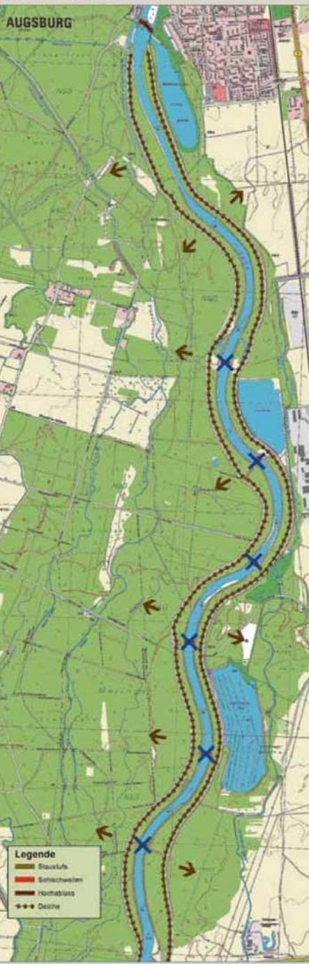
Ideen zum Umbau des Lechs zeigt diese Grafik: Die Aufweitung des Flusses und die Beseitigung bestehender Schwellen sind mögliche Maßnahmen, um dem Lech wieder mehr Raum und Dynamik zu geben. Es sind Ideen, die diskutiert werden. Wie sie konkret umgesetzt werden könnten, wird im weiteren Prozess von Licca liber entwickelt.
